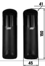
ACG8046 NOVA (no/nf) portée signal infrarouge 15÷40m faisceau infrarouge réglable 180° synchronisme jusqu'à 4 paires gère 2 barre palpeuse no/nf 8.2KΩ IP 44 - 12/24V ac/dc
