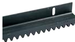
ACS9080 CRÉMAILLÈRE M6 en métal à traiter (sect. 30 x 30 mm) avec cornière 45x45 mm en barres de 2 m au m
